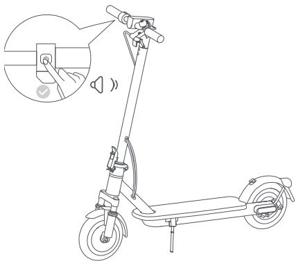
FI Huomautus: Turvallisuutesi vuoksi uutta skootteria ei voi täysin aktivoida ennen kuin se on yhdistetty matkapuhelimesi; se tuottaa äänimerkin jatkuvaltä käynnistyksen jälkeen ja sen nopeus on rajoitettu 10 km/h:iin.
