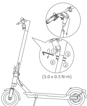
FI Asenna ohjaustanko runkoon ja varmista, että asennat ohjaustangon oikeaan suuntaan. Noudata kuvassa esitettyä numerojärjestystä neljän ruuvin esikiristämiseksi muakana toimitettulla kuusiokoloavaimella. Varmista, että ohjaustanko on asennettu oikein, ja kiristä ruuvit huolellisesti.
