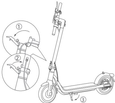
2. Prima o bloqueio de segurança e empurre a alavanca de libertação rápida para fora. Depois, gire o guidão 90° no sentido anti-horário e empurre a alavanca de libertação rápida para dentro.
