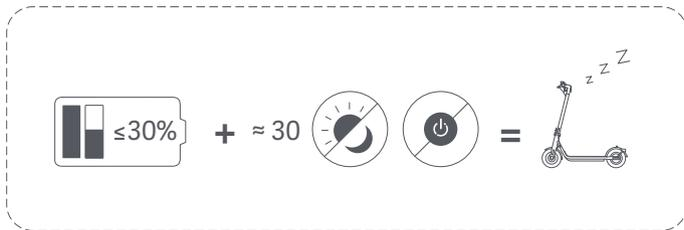
Quando a trotineta estiver desligada por cerca de um mês sendo o nível de bateria da trotineta menor que 30%, a trotineta irá entrar no modo dormir. Neste caso, não será possível ligar a trotineta. Para sair do modo dormir, carregue a trotineta por cerca de três segundos para ativar a bateria.
